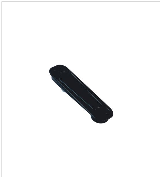
Poignée cuvette escamotable pour coulissant simple permettant le croisement des vantaux. A encastrer, nécessite un fraisage oblong 28x124mm. Embase ovale 130 x 32 mm. Carré de 7 mm, entraxe de fixation 43 mm. Livrée avec fixation.
