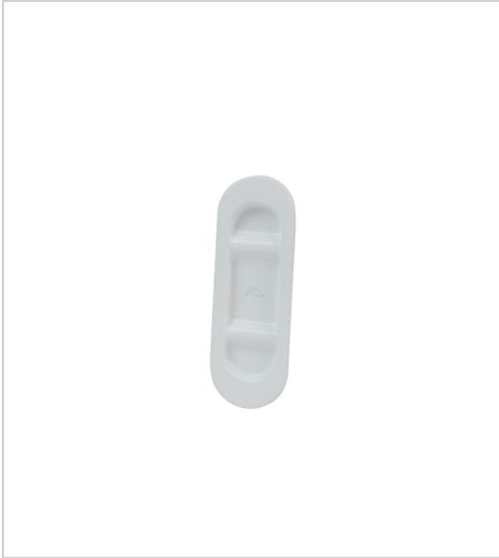
Poignée cuvette ROTO LINE pour coulissant simple, côté extérieur. A encastrer, nécessite un fraisage oblong 30x90mm. Embase ovale 112x38mm. Entraxe de fixation 43mm. Set de fixation à commander séparément.
