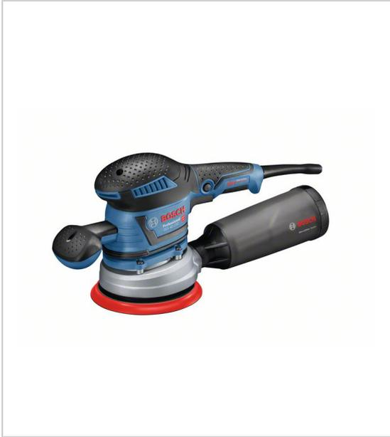
Présélection de la vitesse pour une utilisation sur de multiples matériaux boîtier collecteur de poussières avec système microfiltre intégré système de fixation auto-agrippant plateau de ponçage multi-trous pour une aspiration parfaite des poussières système d'amortissement des vibrations innovant livrée en coffret L-BOXX avec 1 feuille abrasive grain 120, clé Allen, micro-filtre, plateau de ponçage Ø 150 mm, poignée supplémentaire.
