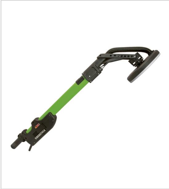
Ponçage de murs et plafonds à cloison sèche, panneau d'isolation thermique élimination de résidus démarrage progressif, protection électronique de surcharge moteur : électrique 230 V-590 W Ø du plateau : 225 mm livrée avec sac de transport, rallonge, jeu de 3 papiers émeri et 1 brosse.
