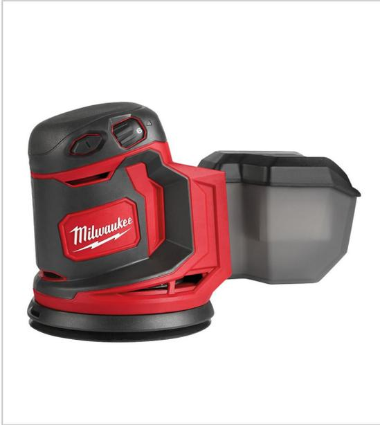
Electronique REDLINK protégeant la batterie et l'outil contre les surcharges et les surchauffes 6 réglages de vitesse bac à poussière équipé d'un filtre pour une meilleure gestion des poussières plateau de ponçage universel Ø 125 mm adaptateur fourni pour s'adapter à tous les aspirateurs MILWAUKEE® nombre d'oscillations : 14000-24000 osc/min livrée avec sac à poussière, adaptateur d'aspirateur, extension, 2 disques de ponçage sans batterie, ni chargeur.
