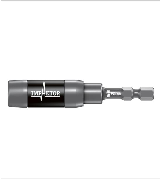
Porte-embouts Impaktor permettant d'amortir les pics d'impulsion extrêmes effet « torsion » très poussé grâce aux deux éléments à ressort avec aimant annulaire, pour un maintien aisé des vis même longues et lourdes l'aimant est rétractable, ce qui permet sa neutralisation convenant pour embouts à emmanchement hexagonal 1/4 " selon DIN 3126-C 6,3 et de la série 1 Wera.
