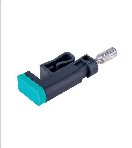
P uissance de serrage 30K g ouverture jusqu'à 24 mm augmente les possibilités d'utilisation des serre-joints à rail outil de serrage spécial pour l'encollage de bandes de chant ou de moulures pour le serrage d'appoint en plein panneau (p. ex. moulure de porte) accessoire pour tous les serre-joints à rails de section 8 x 30 mm max. (serre-joints à une main ou serre-joints à vis) .
