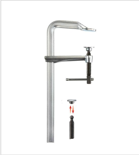
Particulièrement adapté au travail du métal mais aussi du bois puissance de serrage jusqu'à 60 00 N poignée à garrot à bouts ronds pour un bon confort au serrage rail et valet monobloc étiré à froid, traité et zingué pour une résistance maximale à la corrosion coulisseau forgé et traité rotule amovible les presses à vis tout acier permettent un serrage puissant avec une réserve d'élasticité du rail pour un maintien exceptionnel au serrage.
