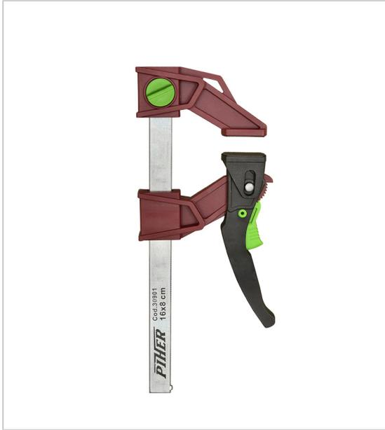
Puissance de serrage 120 kg mâchoires légères en nylon et fibre de verre rail zingué de 20 x 5 mm deux plaques de frein en acier incorporé dans la tête mobile capuchons de protection fabriqués en caoutchouc Thermo-propylen.
