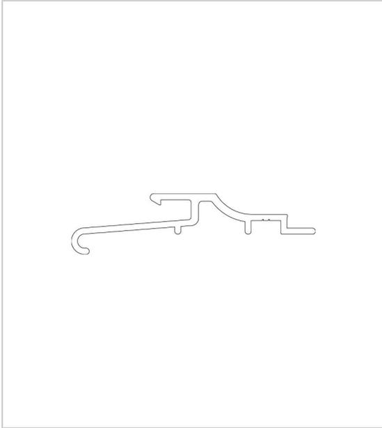
Profil alu de protection de passage à clipper sur le profil PVC pour constituer le seuil REHAU sous avis technique N°6/11-2003\_V1.
