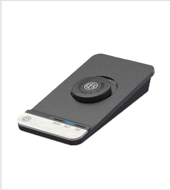
Permet la programmation en hors ligne de cylindres électroniques et garnitures électroniques et badges
