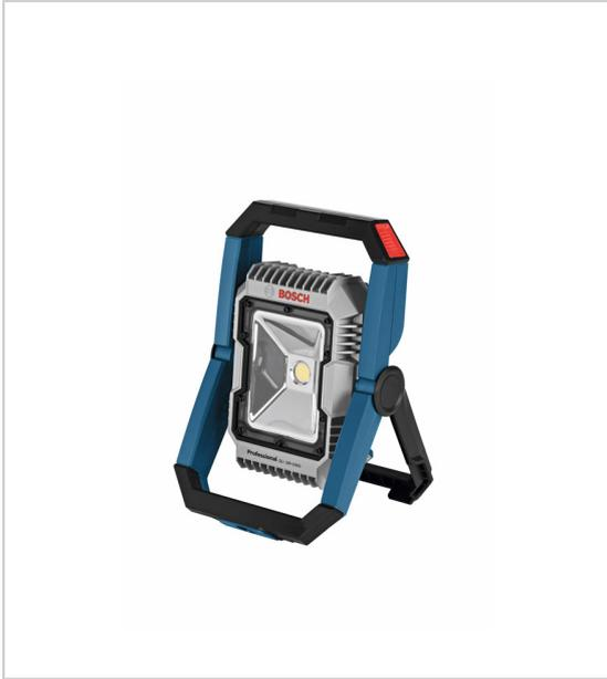
Puissante LED produisant jusqu'à 1 900 lumens pour un éclairage parfait interrupteur ON/OFF cadre solide pour une bonne prise en main et une grande solidité sur les chantiers 2 niveaux de luminosité 5 orientations possibles filetage de trépied 5/8 " angle d'inclinaison : 120 ° compatible avec batteries 14,4V et 18V autonomie de 8 h avec une batterie 18V 5Ah sans batterie, ni chargeur.
