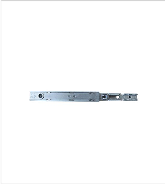
Prolongateur avec sortie de tringle de 18mm pour crémones, avec inverseur pour le verrouillage en partie basse, raccordable par crémaillère.
