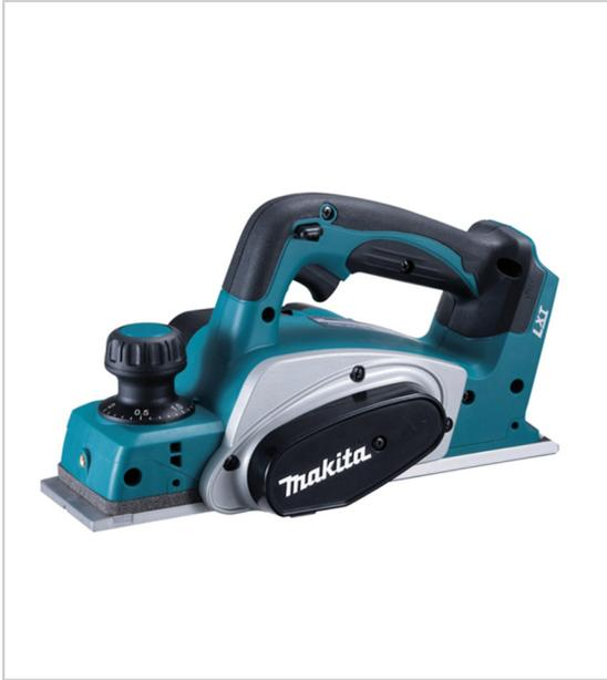
Semelle avec rainure en V pour faciliter le chanfreinage frein électrique arrêtant la machine dès qu'on lâche la gâchette réglage précis de la profondeur de coupe par pas de 0,1mm pied de protection escamotable pour éviter d'endommager la lame et la pièce à travailler poignées caoutchoutées et antidérapantes palier de roulement en aluminium vitesse à vide : 15000 tr/min livré avec calibre de réglage, clé à douille, guide parallèle sans batterie, ni chargeur.
