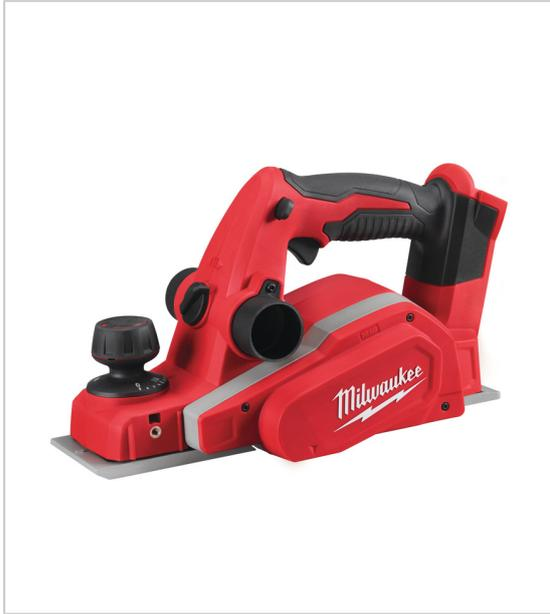
Protection contre les surcharges et les surchauffes double lame en carbure réversible protégée par un patin de repos escamotable semelle en magnésium réglable dans 20 positions différentes rainure en V idéale pour les chanfreins éjection des copeaux à droite ou à gauche avec sac récupérateur ou raccordement à un aspirateur vitesse à vide : 14000 tr/min livré avec jeu de lames réversibles, sac à poussière, guide parallèle, adaptateur de poussière sans batterie, ni chargeur.
