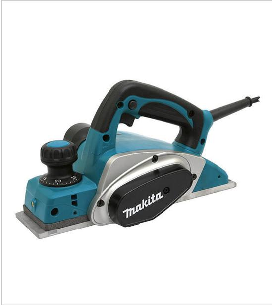
Réglage de la profondeur de coupe par pas de 0,1 mm pied de protection escamotable éjection des copeaux améliorée poignées caoutchoutées et antidérapantes palier de roulement en aluminium cordon d'alimentation de 2,5 m livré en coffret MAK-PAC avec calibre de réglage, clé à douille, raccord poussière.
