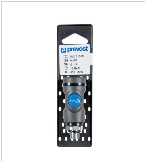
Profil : ISO 6150B sécurité "one push" (anti-coup de fouet) pression d'utilisation : 2 à 12 bar débit sous 6 bar :833 l/min Ø de passage : 6 mm température :-15°C à +70°C matière : corps composite point fort : anti-rayures antistatique.
