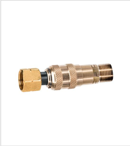
Permet un débit d'acétylène de 160 litres par heure utilisable sur une lance rigide, il permet d'intervenir sur des épaisseurs de l'ordre de 1 à 2 mm en soudage acier et sur des tubes cuivre de diamètres compris entre 10 à 14 mm par 3 pièces.
