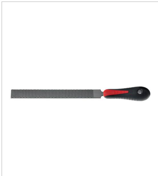
Acier moins chargé en carbone (0,45 %) pour un travail efficace sur les matériaux tendres dureté de 53 HRC manche bi-matière : polypropylène (résistance et relief permettant de travailler avec précision) et élastomère (souple et confortable - limite la transpiration et l'échauffement de la main).
