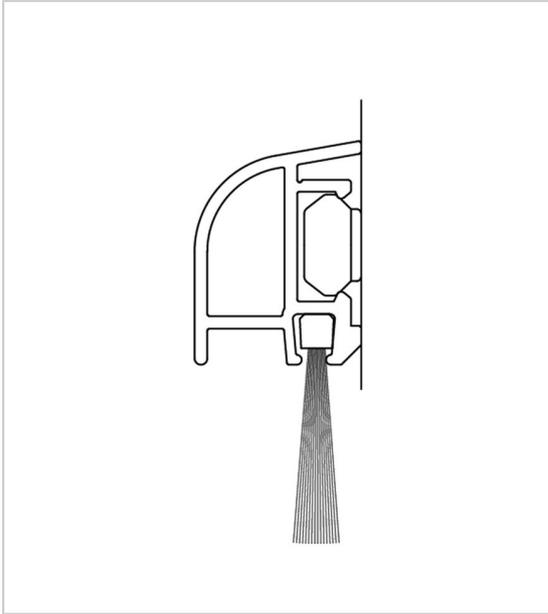
Rejet d'eau en aluminium pour améliorer l'étanchéité à l'eau de la partie basse des portes et portes-fenêtres PVC.
