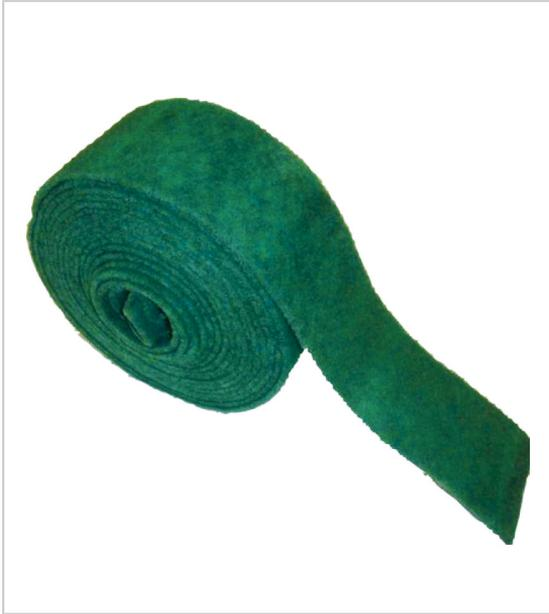
Structure ouverte en texture fibre de nylon non tissée évitant un encrassement prématuré grain corindon produit très flexible pouvant s'adapter à tous les contours et toutes les formes résistant à l'eau et à l'huile ponçage manuel sur tous métaux, bois, plastiques, surfaces peintes, nettoyage de la rouille sur des pièces métalliques, donne un aspect mat aux surfaces métalliques, atténuation des défauts de finitions sur cuves inox et sur profilés aluminium, ébavurage dimensions : 115 mm x 10 m.
