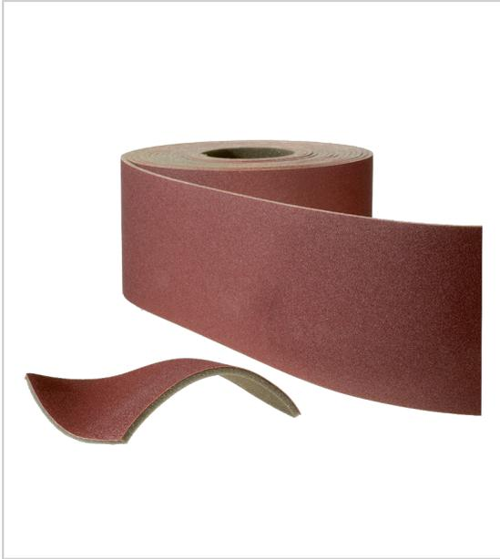
Support toile cotonnée à haute flexibilité J-FLEX abrasif corindon distribution granulométrique fermée longue durée de vie et bon enlèvement de matière même sous faible pression pour le ponçage manuel du bois, d'enduits, des laques... dimensions : 115 mm x 25 m.
