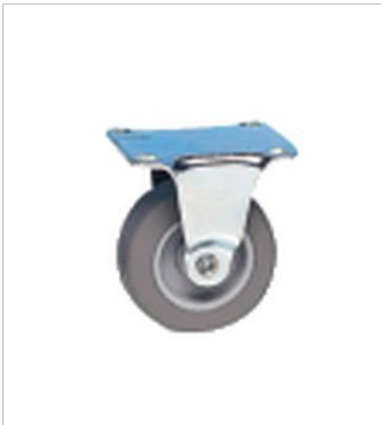
Pour charges légères sur sols intérieurs monture en tôle d'acier emboutie zinguée pivotement sur une couronne de billes bandage caoutchouc thermoplastique gris non tachant corps de roue polypropylène.
