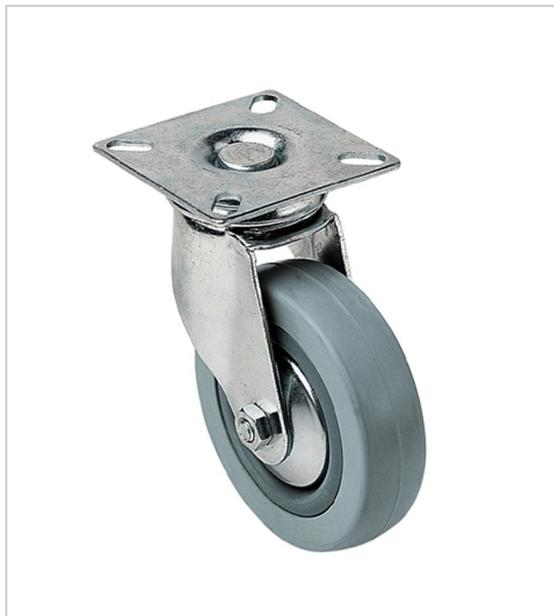
Pour manutention légère d'appareils ou mobiliers monture en tôle d'acier emboutie zingué pivotement sur 2 couronnes de billes corps de roue polypropylène gris, bandage caoutchouc souple gris non tachant moyeu lisse, pare-fils zingués, axe boulonné démontable.
