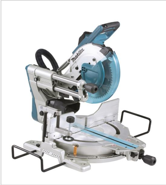
Technologie DXT pour des coupes larges et précises guidage laser capacité de coupe (I/P) 90°/0° : 91 x 279 mm capacité de coupe (I/P) 90°/45° : 91 x 197 mm hauteur de coupe à 45°, pivot à 45° : 43 mm inclinaison (biaise) droite/gauche : 60/60 ° pivot (onglet) droite/gauche : 48/48 ° classe du laser 2M livrée avec lame carbure bois 60 dents.
