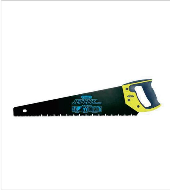
Denture JetCut 7 dents / pouce spéciale plaque de plâtre lame en acier de qualité suédoise de 0.85 mm d'épaisseur traitement denture HardPoint 2x avec avoyage alterné (longévité accrue, meilleure pénétration) traitement de lame Armor anticorrosion + réduction des frictions poignée ergonomique bimatière antichoc, vissée et soudée, pour gaucher et droitier poignée permettant un traçage à 45° et 90°.
