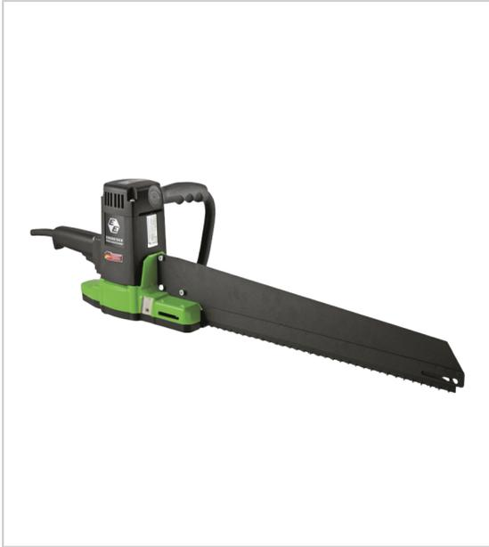
Conçue pour couper toute sorte de matériaux : brique, brique alvéolaire, béton cellulaire, plastique, PVC, bois... moteur robuste et puissant deux lames de scie travaillant en sens opposé : coupe nette et fluide ventilateur protégeant la transmission et l'utilisateur contre la poussière poignée ergonomique et réversible moteur électrique 230 V vitesse de rotation : 2200 tr/min livrée avec 1 jeu de 2 lames et 1 outillage poids : 6,1 kg.
