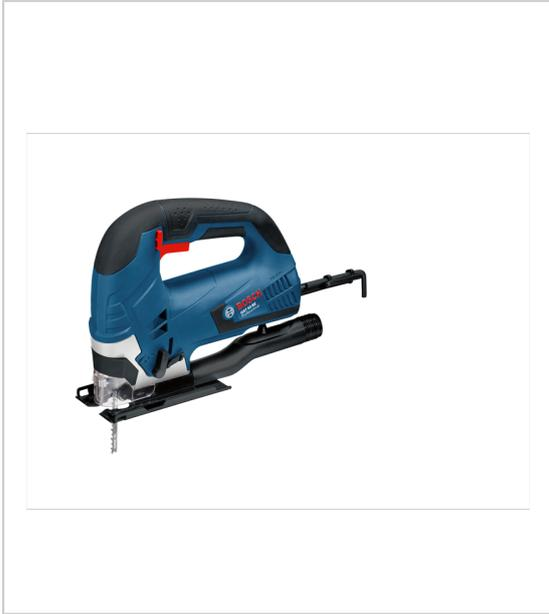
Changement de lame facile et sans clé grâce au système SDS plaque de base indéformable en acier fonctionnement silencieux lors du sciage mouvement pendulaire de la lame réglable dans 3 ou 4 positions régulation électronique pour une meilleure adaptation au matériau soufflerie de copeaux pour une vue dégagée câble de 2,5 m livrée en coffret avec kit d'aspiration, clé six pans mâle 5 mm, dispositif pare-éclats, 1 lame de scie.
