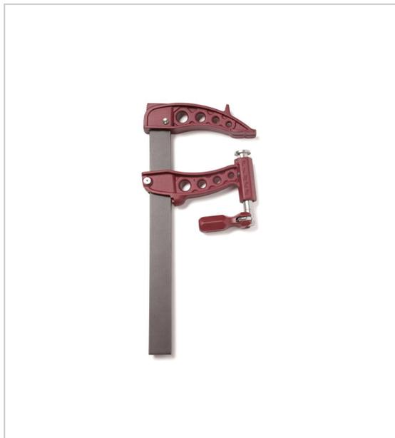
Système exclusif de positionnement du coulisseau serrage avec système de piston et filetage non-apparent graisseur intégré pour la lubrification de la visserie manche de serrage multiposition et démontable puissance de serrage : 10000N.
