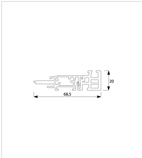
Seuil de porte aluminium à rupture de pont thermique pour portes d'entrée et portes-fenêtres Aluplast 4000.
