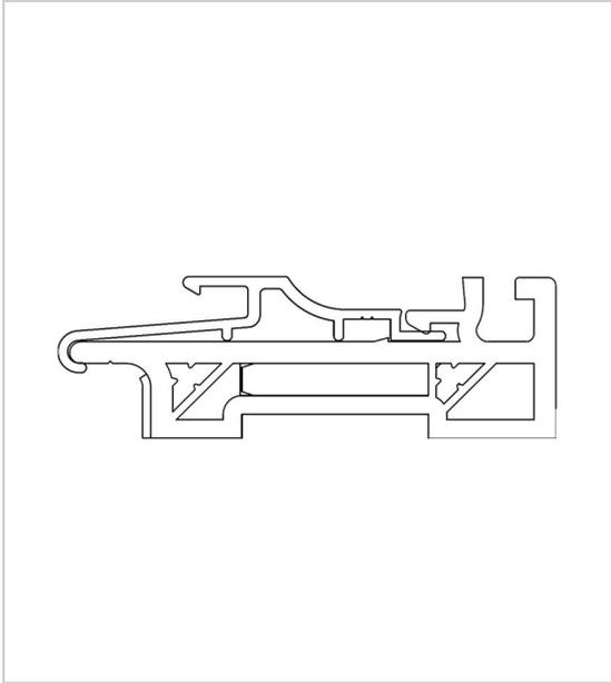
Seuil de porte PMR pour gamme REHAU S729, à rupture de pont thermique, sans ailette, hauteur 20 mm.
