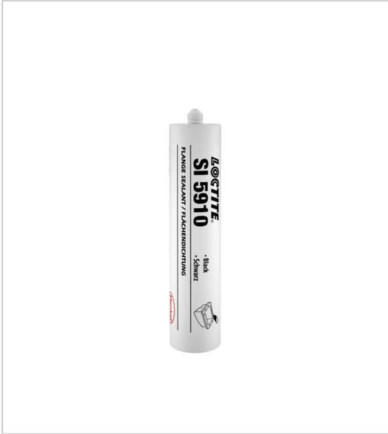
Pour l'étanchéité de carters en tôles embouties, couvercle de boîte de distribution, carter d'huile utilisation où une bonne résistance aux huiles est requise ainsi qu'une bonne aptitude à supporter des mouvements importants du joint le caractère thixotrope du LOCTITE 5910 évite la migration ou le fluage du produit après application sur les surfaces
