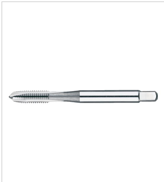
Très approprié pour aciers, inox, fontes, aluminium et ses alliages, cuivre et ses alliages approprié pour alliages de nickel, cobalt et titane Form B (coupe GUN) pas métrique matière de l'outil : HSS-E (8% de cobalt) surface non revêtue queue cylindrique renforcée avec carré (hors M12 : queue cylindrique dégagée avec carré) coupe à droite type de trou : traversant angle au sommet : 60° entrée 4 - 5 filets tolérance : ISO 2 / 6H / h9.
