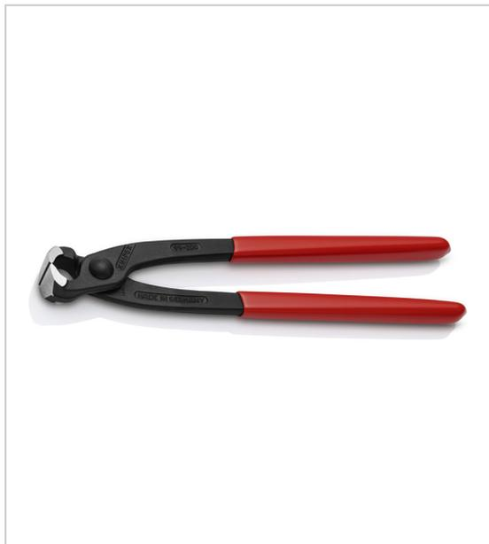
Pour torsader et couper des fils à ligaturer en bobine en une seule opération : rapide, fiable et économique. Tranchants trempés, dureté d'env. 61 HRC. Finition noire atramentisée et tête polie poignées gainées en plastique.
