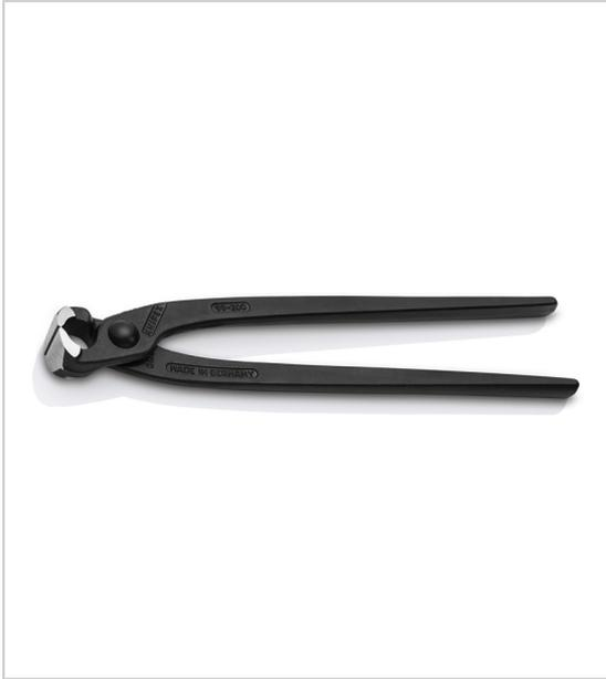
Pour torsader et couper des fils à ligaturer en bobine en une seule opération : rapide, fiable et économique tranchants trempés, dureté d'env. 61 HRC finition noire atramentisée et tête polie.
