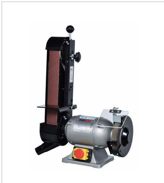
Touret à meule/bande, moteur monté sur roulements à billes surface de ponçage de la bande 50 x 250 mm sortie pour aspiration Ø 36 mm interrupteur avec bobine anti-redémarrage porte outil réglable interrupteur coup de poing dimensions (L x l x H) : 450 x 250 x 570 mm poids (Kg) : 14 livré avec plexis de protection, meule 150 x 25 mm Gr 36, bande de 50 x 1000 mm, manuel d'utilisation et clés de services.
