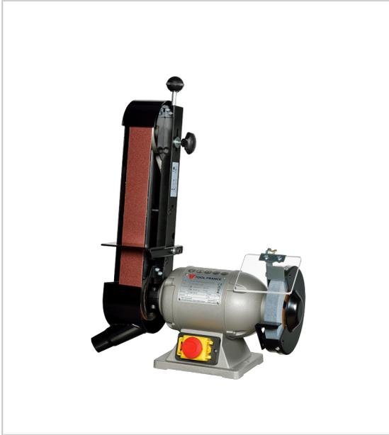
Moteur monté sur roulements à billes surface de ponçage de la bande 50x250 vitesse de la bande : 15m/secsortie pour aspiration Ø36mm interrupteur avec bobine anti-redémarrage porte outil réglable interrupteur coup de poing dimensions H x l x L (mm) : 450x250x570 poids (kg) : 14 garantie : 3 ans livré avec plexis de protection, meule 150x25mm Gr36, bande de 50x1000mm, manuel d utilisation et clés de service.
