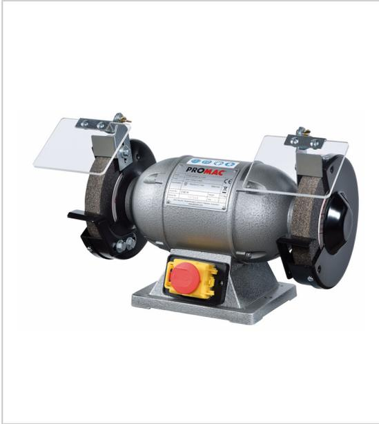
Interrupteur avec bobine anti-redémarrage livré avec interrupteur coup de poing, plexis de protection, meule 150x25x20mm en grain 36 et 60, manuel d'utilisation et clé de service.
