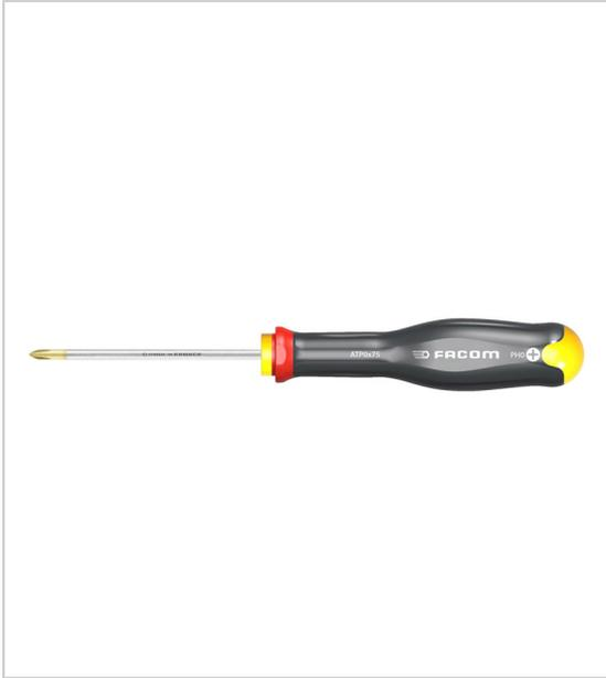
Lame extra-longue jusqu'à 400 mm pour un accès difficile et éloigné traitement thermique en ligne manche Soft Grip résistant aux produits chimiques traitement « tri-coating » de la lame (Zinc-Nickel-Chrome) ergonomie optimisée du manche marquage laser pour une meilleure résistance à l'usure usinage des empreintes par commande numérique.
