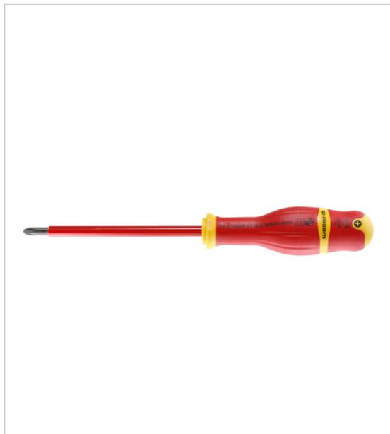
Traitement thermique en ligne matière du manche : Soft Grip traitement « tri-coating » de la lame (Zinc-Nickel-Chrome) ergonomie optimisée du manche marquage laser usinage des empreintes par commande numérique testé individuellement à 1000 V pendant 10 secondes.
