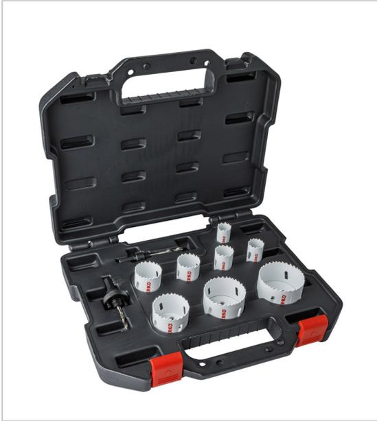
Idéal pour les électricienstechnologie HSS M42 bimétal avec 8% de Cobalt pas variable pour le perçage des aciers, inox, non ferreux, bois, plastiques, cloisons sèches utilise sans percussion l'utilisation d'un lubrifiant est conseillée pour le perçage des métaux et des non ferreux. composition :- 8 scies trépan (Ø 22-25-29-35-40-51-60-67 mm), profondeur 38 mm- 1 arbre 42001 (14 à 230 mm) - 1 arbre 42006 (32 à 210 mm).
