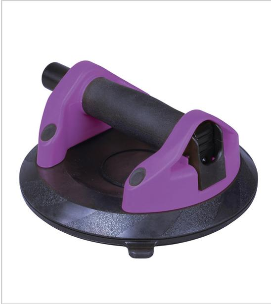
Ventouse à pompe utilisant le vide pour soulever, tenir et placer des matériaux lisses et non poreux tels que: le carrelage, les dalles sur plot, le marbre, les plaques de granit, le verre et les surfaces rugueuses témoin rouge d'indication de perte d'adhésion levier de décompression pour retirer rapidement la ventouse poignée Bi-matière résistante pompe ABS livrée dans sa mallette de transport.
