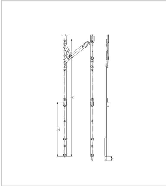
Verrou de semi-fixe de sécurité pour porte d'entrée avec une gâche galet intégrée (pour serrures type 1).
